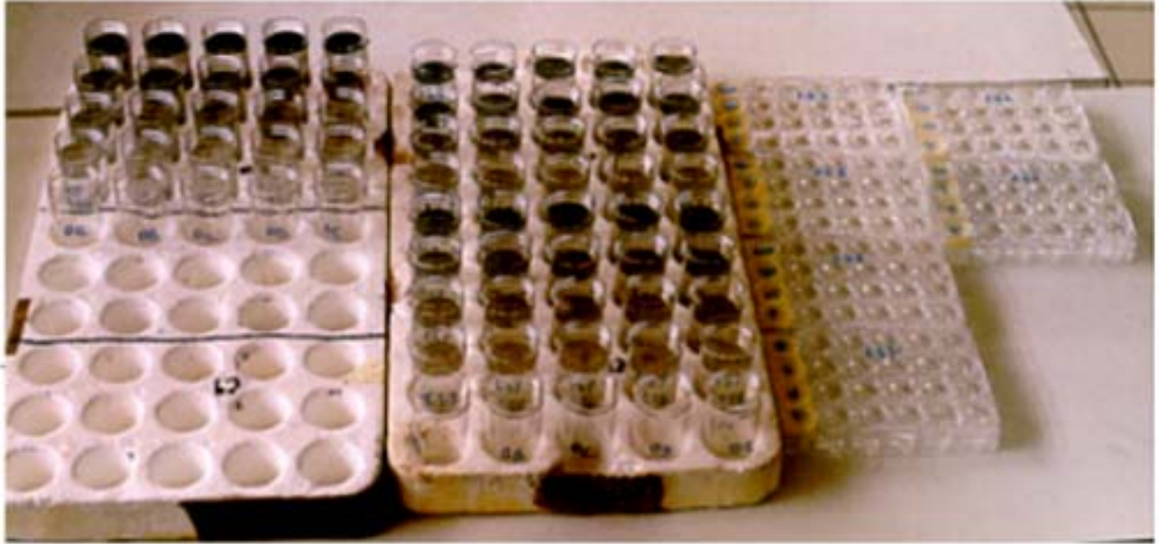
Photo 1 : Présentations des puits utilisés pour la réalisation des tests d'embryotoxicité. À gauche, sont présentés les pots de 30 ml en polystyrène utilisés avec le sédiment contact et à droite les puits de 3 ml, sur des plaques Nunc, qui sont utilisés avec les éluviats.
